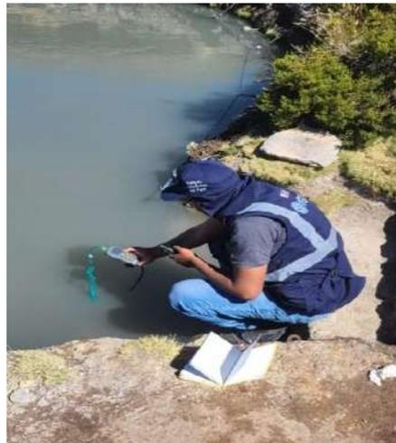
*Figura 10.-Instalación del termómetro, medición de temperatura y toma de coordenadas de la fuente.*
